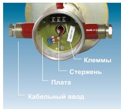
Рис. 2. Устройство корпуса
